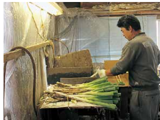
「皮むき機」を使い、空気を噴射してネギの皮をむく。機械導入による生産者の作業負担軽減も進めている
