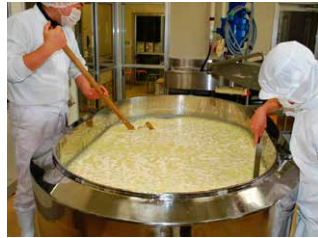
原料乳に乳酸菌を加えて発酵させる。攪拌(かくはん)して発酵を促し、ホエーとカードに分離させる。10キログラムのカードを作るには10倍にあたる100リットルの牛乳が必要
